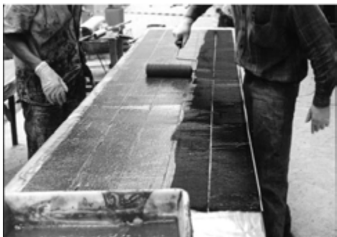
Fotografia 3.3 – Saturação da fibra de carbono na bancada.
