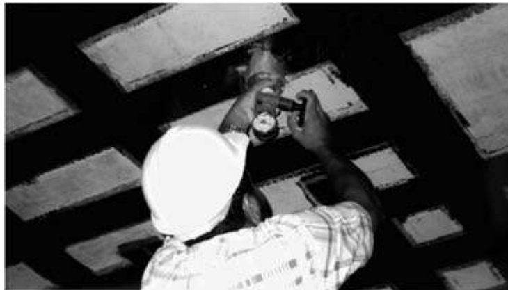
Fotografia 9.14 – Teste de arrancamento do sistema composto aplicado.
