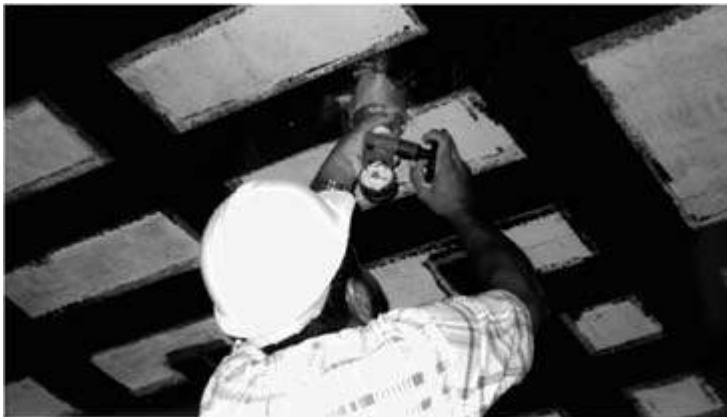
Fotografia 9.14 – Teste de arrancamento do sistema composto aplicado.
