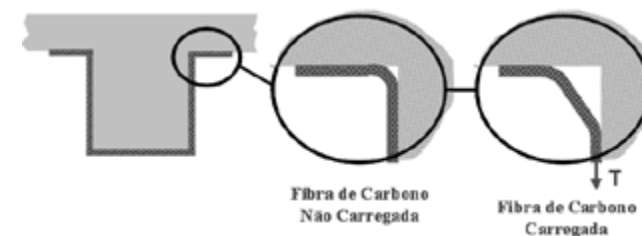
Figura 8.11 – Comportamento do sistema CFC em cantos internos.
